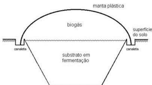
**Figura 40** Biodigestor modelo canadense
