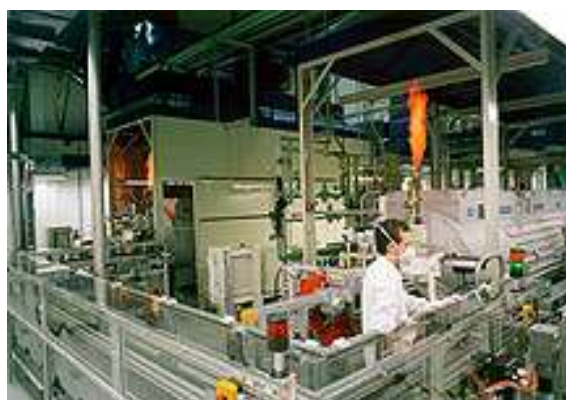
Fig. 56 - Fabricação de Pastilhas de UO 2
