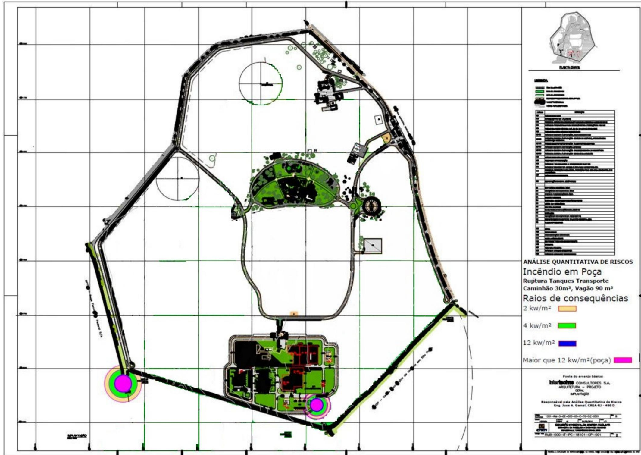
Figura 26 - Resultados do piores cenários – raios de consequências incêndio em poça não-confinada – ruptura de caminhão-tanque e de vagão-tanque na posição rodoviária ou ferroviária mais próximas a áreas sensíveis – radiação térmica.
