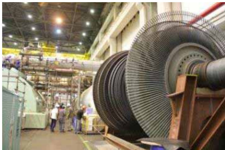
Turbina de Angra 1 durante manutenção planejada As avaliações de fornecedores descritas anteriormente garantem o atendimento, no que se refere à avaliação do alinhamento
